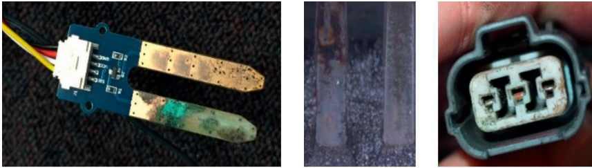
Bild 3. Die Ausgasung von Wärmestabilisatoren oder die Migration anderer ionischer Verunreinigungen im Kunststoff kann zur Korrosion von elektronischen Bauteilen führen (Quelle: DSM)
